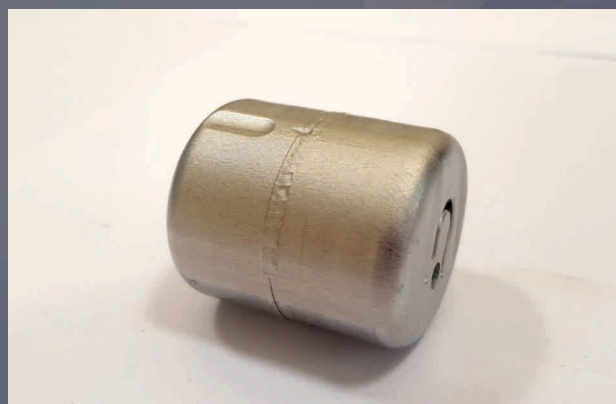
СВАРКА КРУГЛОЙ ДЕТАЛИ ИЗ АЛЮМИНИЯ
