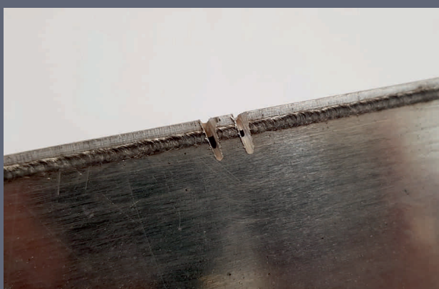
ВЫРЕЗ СВАРНОГО ШВА ЛАЗЕРНОЙ СВАРКИ В АЛЮМИНИИ
