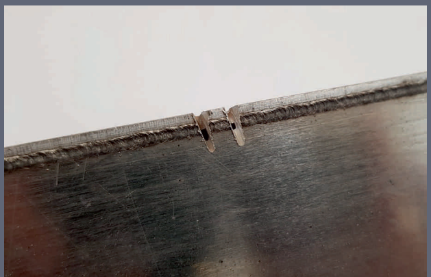
ALIUMINIO SUVIRINIMO SIŪLĒS SKERSPJŪVIS
